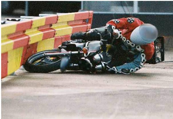
Sowohl der Anprall an die Vertikalelemente als auch der Sturz auf die Längselemente führen in der Regel aufgrund ihrer für den Körperanprall ungünstigen Eigenschaften (fehlende Nachgiebigkeit, Scharfkantigkeit und kleine Querschnitte) zu erheblichen Verletzungen.
