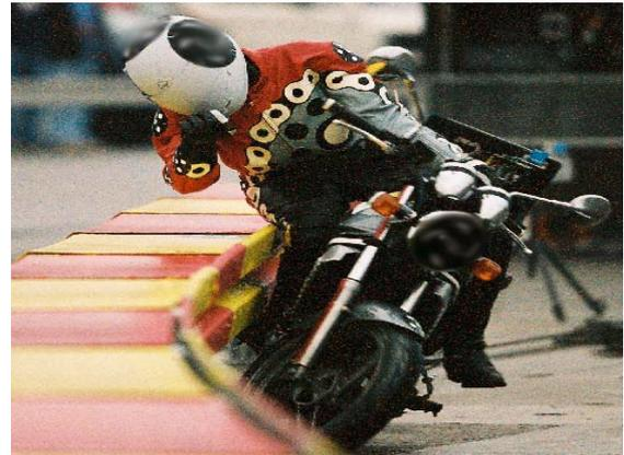
Aussi bien la collision contre les éléments verticaux que la collision sur les éléments longitudinaux conduisent en général à des blessures importantes en raison de leurs propriétés défavorables en cas de collision avec un corps (capacité d'absorption insuffisante, angles vifs et sections trop petites).
